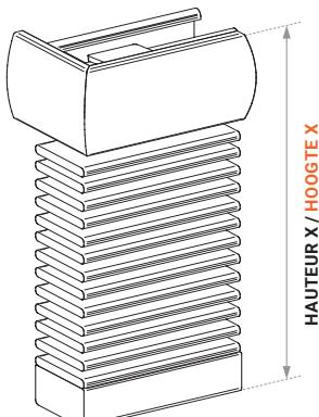
$$\text{Hauteur Hoogte } X = \frac{\text{Hauteur du store (mm)} \times 160}{1000} + 35$$
